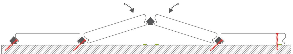
Anschließend werden die Ersatzdiele und die (nicht beschädigte) Nachbardiele mithilfe eines unverschraubten Profix2 Clips, welcher lediglich als Abstandhalter dient, und zweier Klebepunkte wieder in die Terrassenfläche eingebaut.
