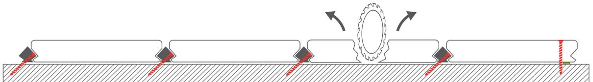
... diese Diele am besten mittels einer – auf die Stärke der Diele eingestellten – Säge längsseitig durchtrennt werden. Die auszutauschende Diele kann nun entfernt werden.
