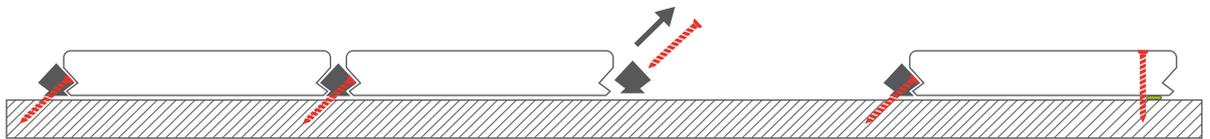
Der nun freigelegte Clip wird entschraubt, damit man die (nicht beschädigte) Nachbardiele anheben kann.
