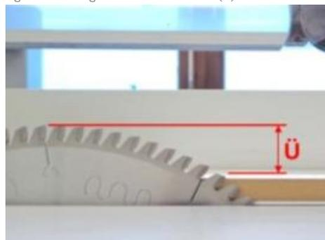
Sägeblätter mit hoher Zähnezahl sind für gute Bearbeitungsqualität generell zu empfehlen. Beim Kreissägen liegt die empfohlene Schnittgeschwindigkeit vc bei 60 – 90 m/s.
