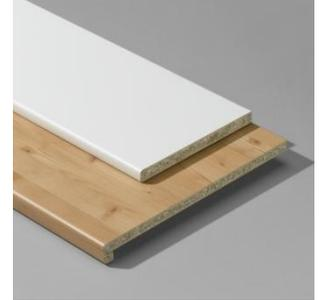
EGGER Fensterbänke sind Verbundelemente, bestehend aus EUROSPAN® Rohspanplatten E1, welche mit dekorativen EGGER Schichtstoff Flex in der Fläche nahtlos beschichtet werden. Zum Schutz vor Feuchtigkeit ist die hintere Längskante der Fensterbank mit einer Melaminkante beschichtet.
